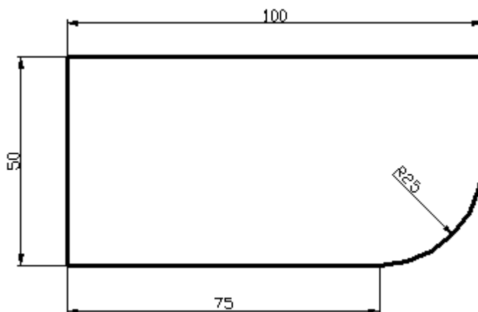
Rysunek 63: Efekt końcowy zaokrąglenia wierzchołka
